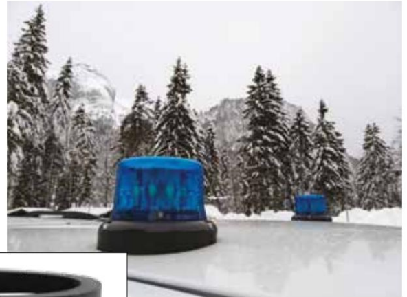
Baliza 3-3541 LP con soporte de goma en ángulo 3-10012 para techos curvos inclinados
