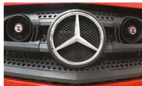
El 8-7050-RC ultracompacto es ideal para montar detrás de la rejilla delantera
